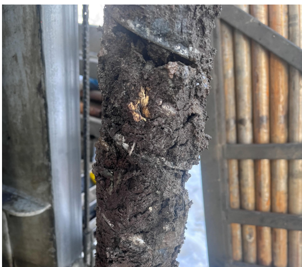
Figur 5 Uttak av masser fra dybde 2-3 meter i borepunkt 12 (Sweco Norge AS, 2024)
