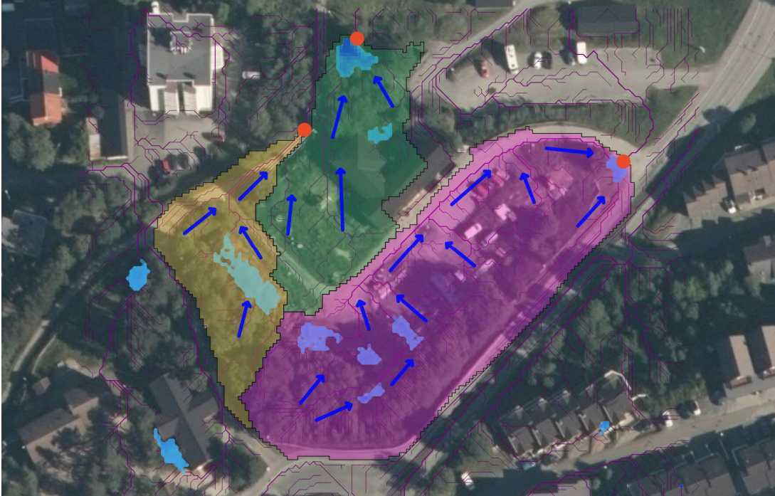
Figur 8 Utsnitt fra Scalgo som viser dagens avrenningsmønster i tiltaksområdet. Tiltaksområdet består av tre delnedbørsfelt (gul, grønn, lilla) og røde markeringer representerer delnedbørsfeltenes utløpspunkt.
