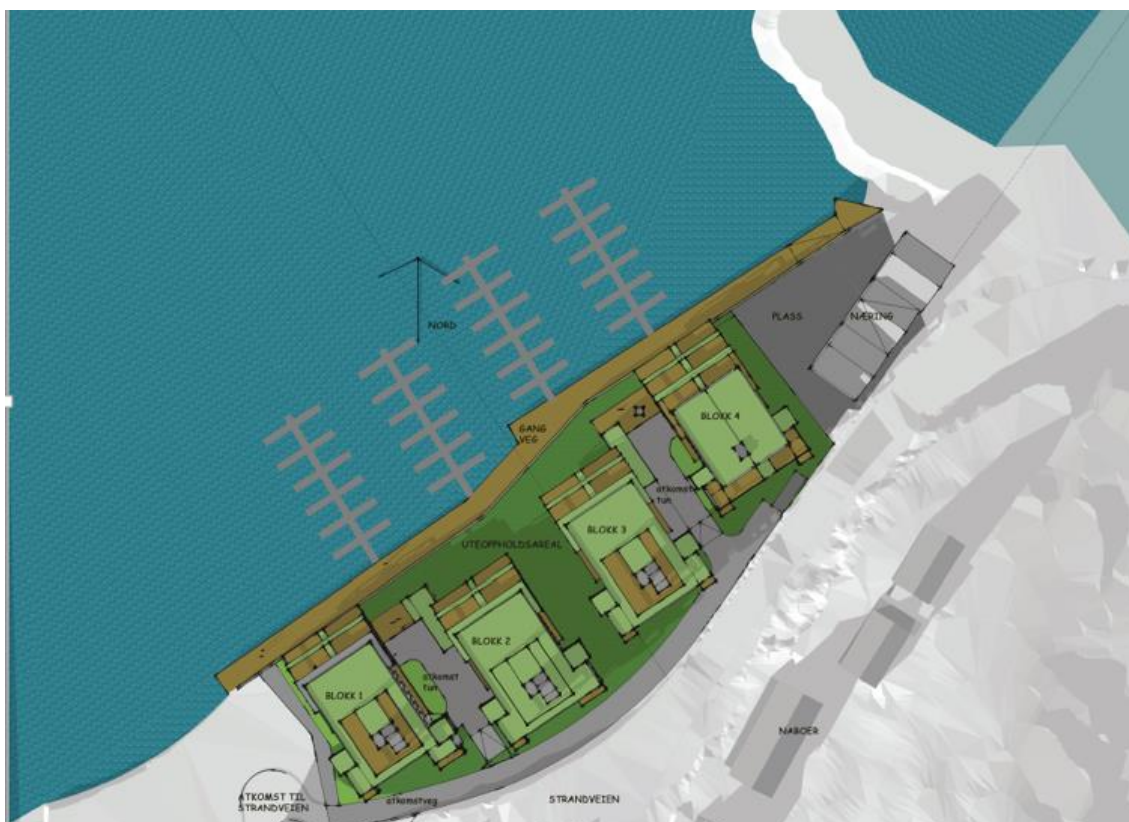
Figur 5-3: Illustrasjon av mulig plassering av flytebrygger i øst.
