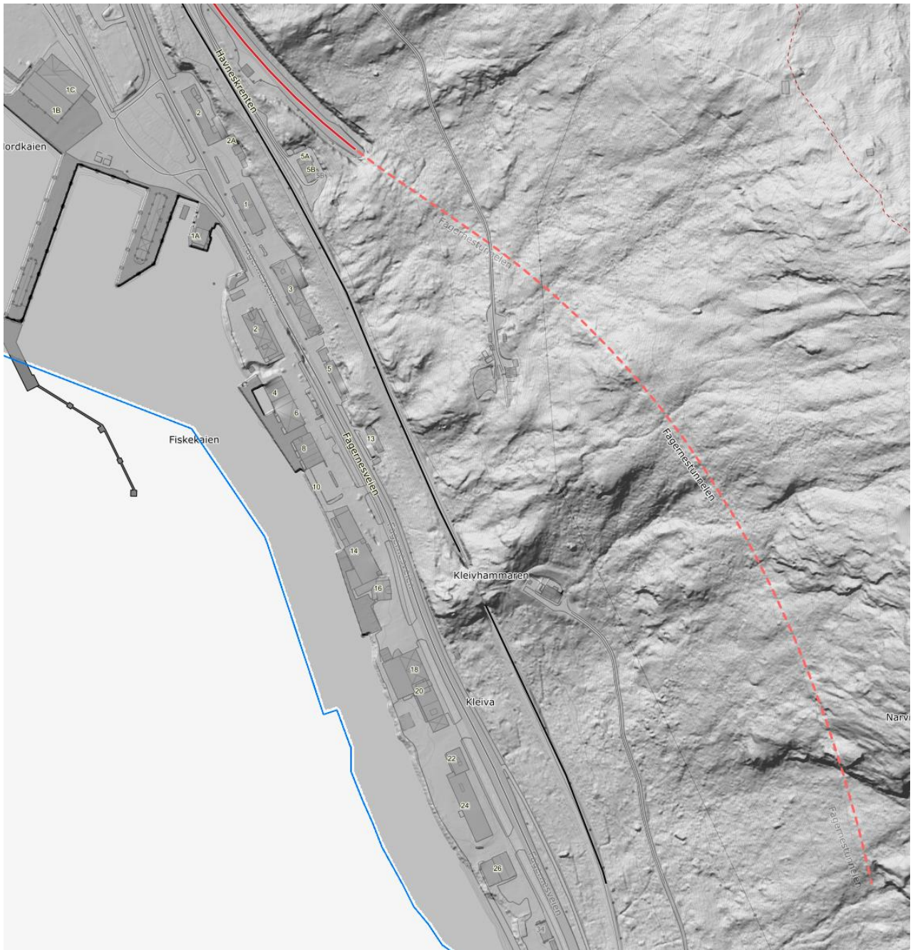
Figur 7 Mer detaljert med forstørret av det nordligsteområdet fra Figur 6, ser tydelige skredbaner som går helt ned mot bebyggelse ved dagens havneterminal, utløpsområde fra Fagernesfjellet.
