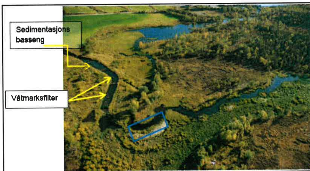
Flyfoto av fangdam med sediment-felle og våtmarksfilter. Disse ble anlagt nederst i jordbrukskanslen etter at denne var rehabilitert. Børselva er nå gjenåpnet og gitt et nytt løp i det gamle elveleiet. I den delen som er markert med en blå firkant ble det gravd ut en riktig stor og dyp kulp (> 5 m - med «langemann»). I dag er denne helt fylt opp med finmateriale, som følge av forsøk med spyleflommer. Årsaken var knyttet til erosjon i avsnittet på strekningen opp til oppstrøms terskel i Børselva. Øverst til høyre ses Børsvannet. Helt til høyre og ca 100 m nedstrøms ligger øvre dukområde.
