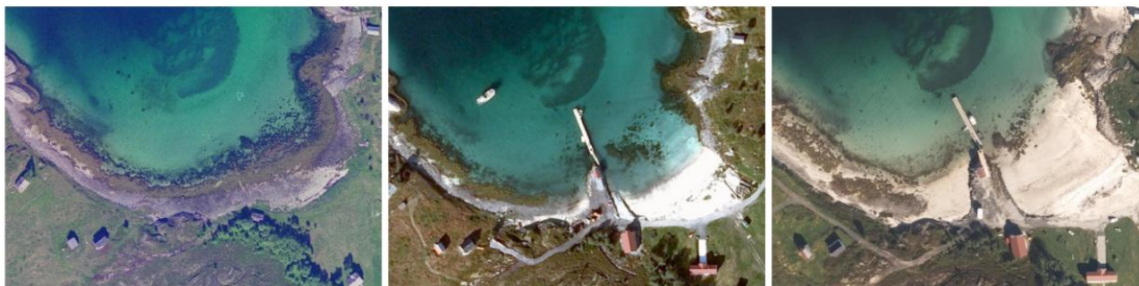
Figur 3. Historiske flyfoto over planområdet viser at stranden og steinmolo ble etablert en gang mellom 2003 (venstre) og 2009 (midten). Bildet til høyre (2015) viser at det har blitt påfylt strandmasser på vestlige del av moloen mellom 2009 og 2015. Kilde: kart.finn.no.
