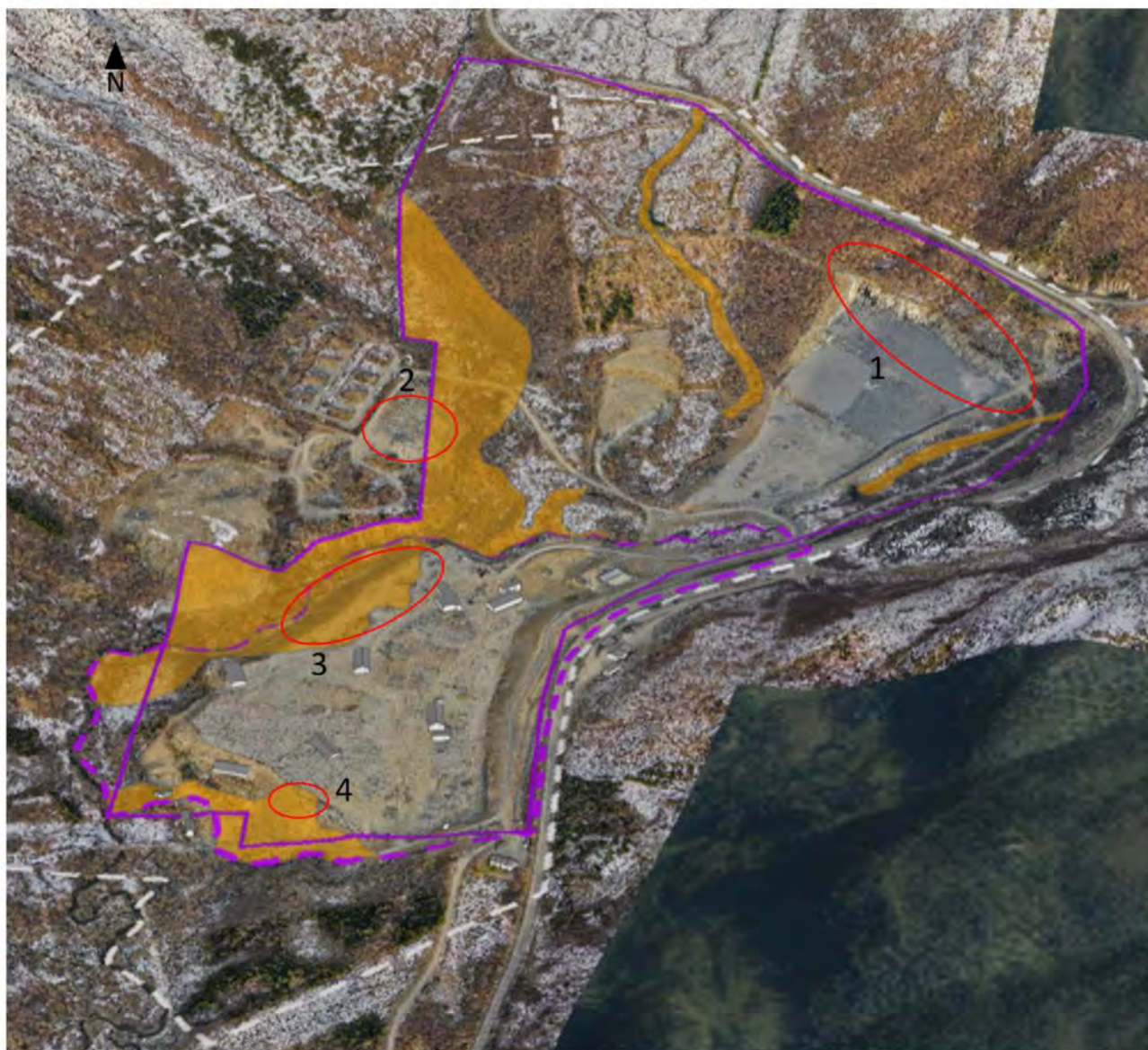
Figur 4-30: Utsnitt av innsynsmodell som viser planområdet (hvit linje), kartleggingsområder for skredfarevurderinger (lilla linjer), faresoner for skred (oransje skravurer) og områder hvor det er utført permanente terrengendringer (røde polygon).
