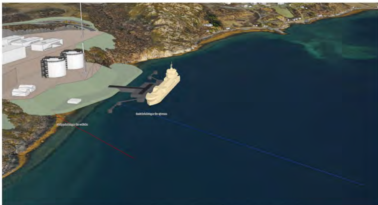
Figur 5-13: Skisse som viser ledninger for inntak av sjøvann (blå strek) og utslipp av saltlake (rød strek)
