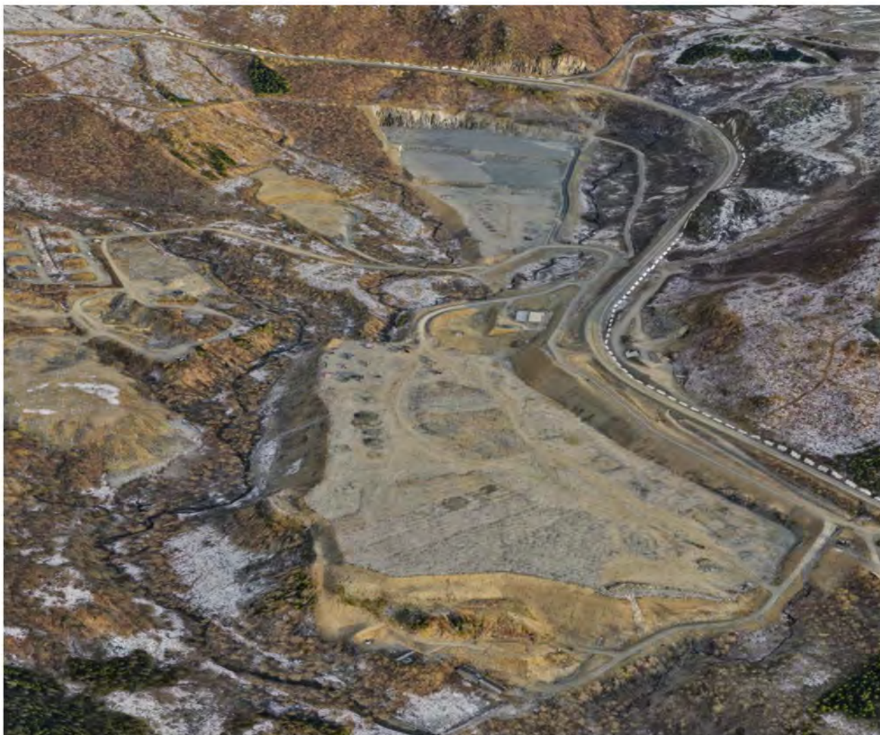
Figur 5-16: Utklipp fra 3D-modell med flyfoto overlagt ved Skoglund som viser gjennomførte grunnarbeider på områdene hvor det foreslås etablert ammoniakkanlegg, hydrogenanlegg og annen industri.
