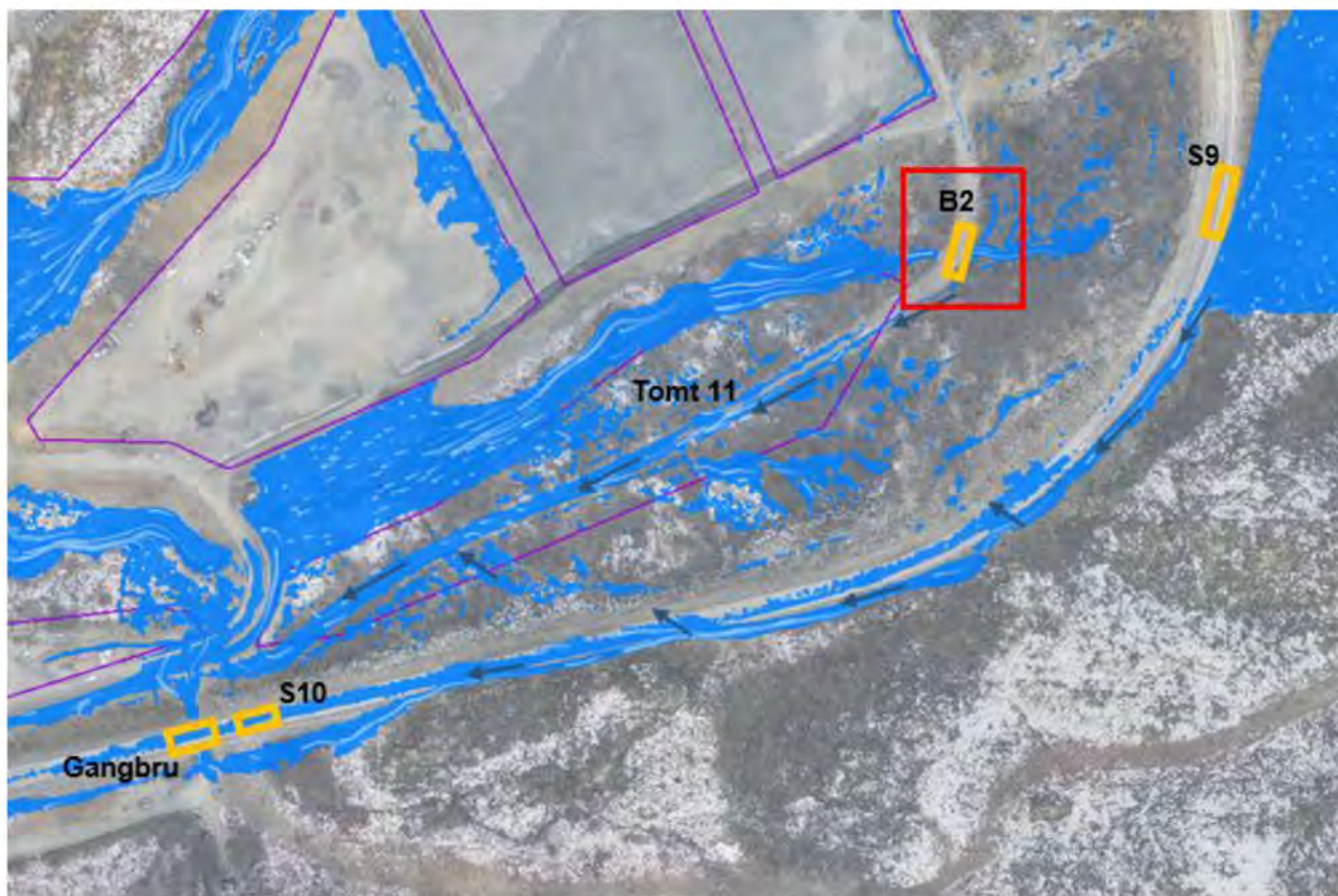
Figur 5-21: Flomutbredelsen i planområdet (tomt 11) på Skoglund inkl. kulverter på E6 ved 200-årsflom inkl. 40 % klimapåslag.
