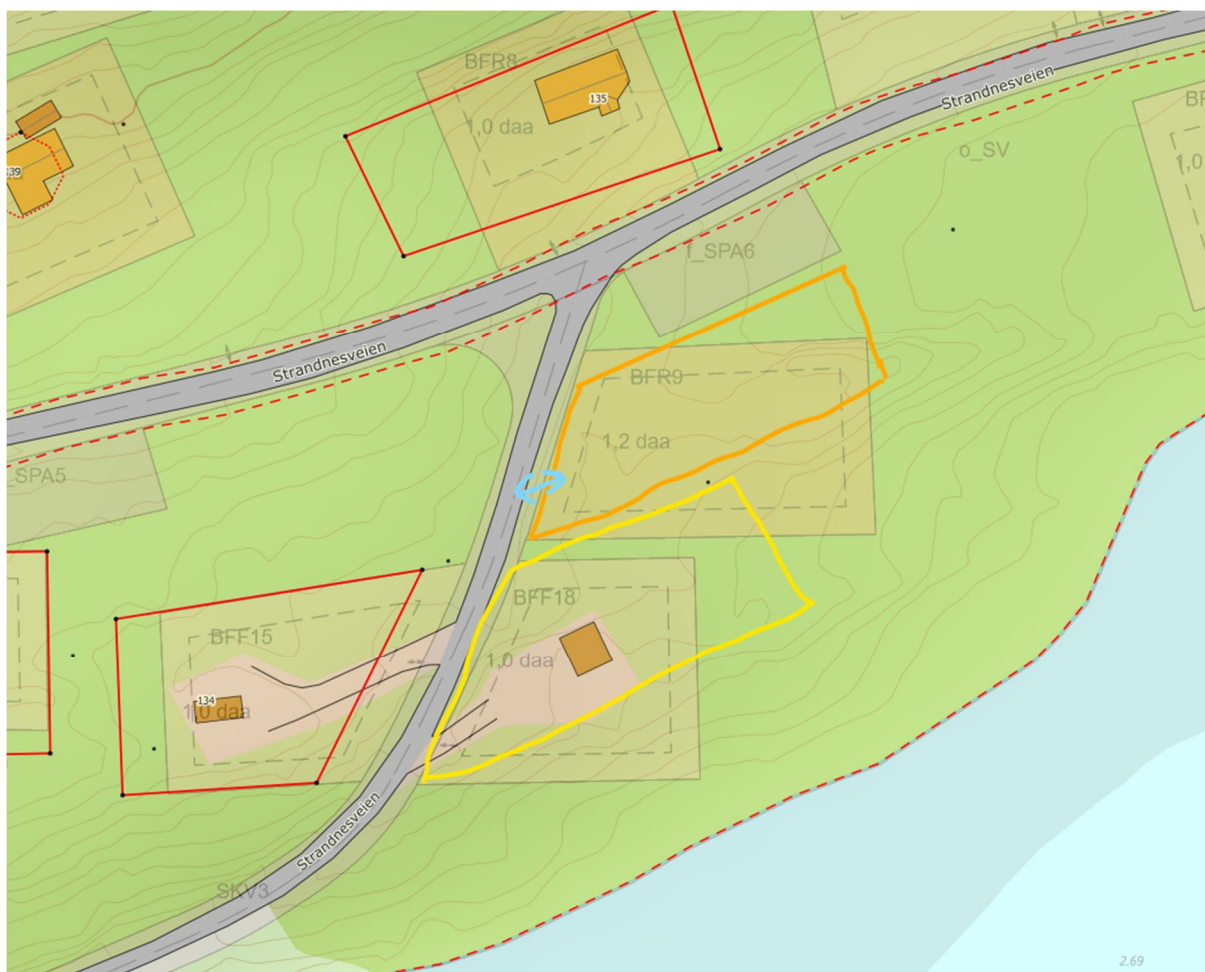
Figur 6. Utsnitt av reguleringsplan som viser tomt BFR9 og BFF18. Gul og oransje strek viser utforming av tomtene og lyseblå pil viser forslag til avkjørselspil for tomt BFR9.
