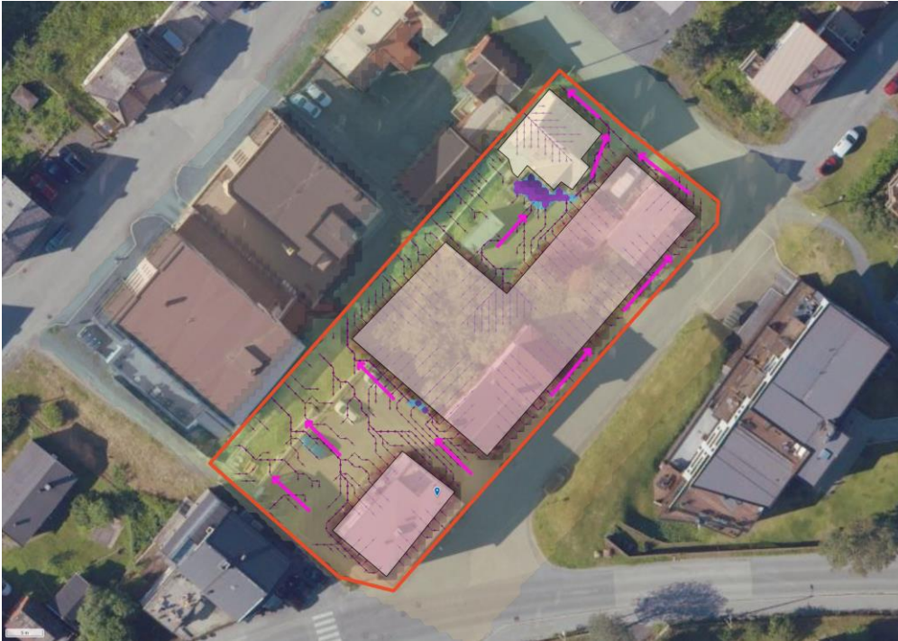
Figur 11: Grov modell av fremtidig avrenningsmønster, utarbeidet i Scalgo.
