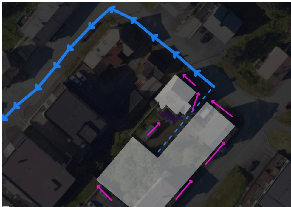
Figur 19: Utsnitt fra Scalgo. Blå stiplede linje markerer forslag til flomvei. Blå piler viser eksisterende flomvei via Brannbakken. Lilla piler markerer avrenningsmønsteret internt i tiltaksområdet.
