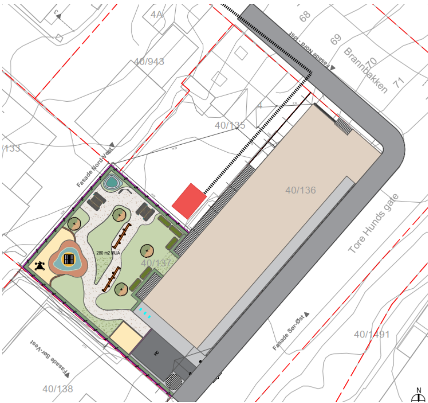
Figur 15: Forslag til plassering av fordrøyningsmagain, markert med rødt (alternativ 1).
