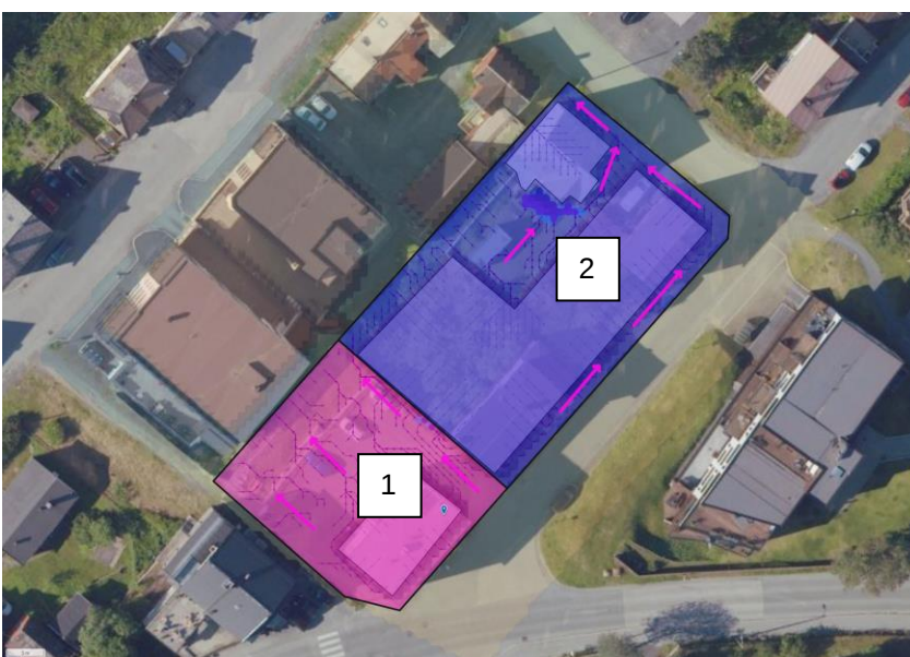
Figur 12: Utsnitt fra Scalgo som viser fremtidige delnedbørsfelt.
