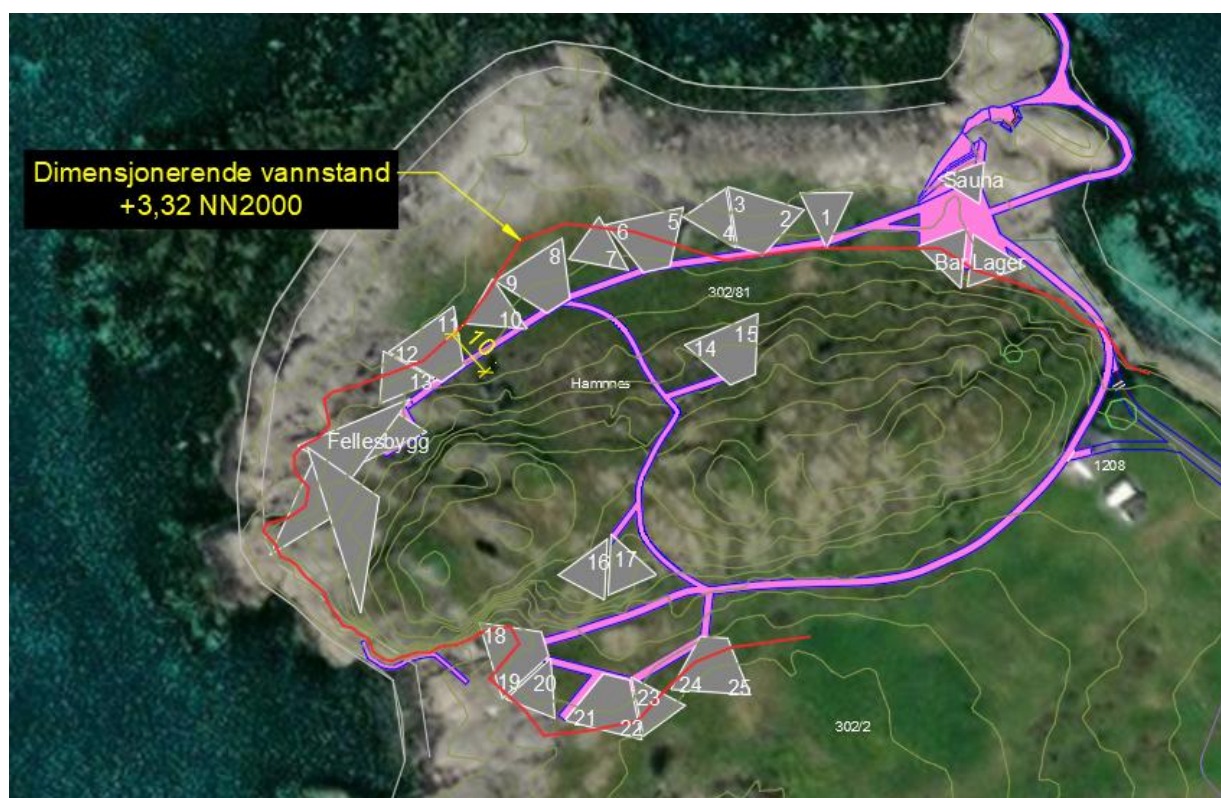
Figur 1 Dimensjonerende vannstand (stormflo + havnivåstigning) samt foreløpig plassering av bebyggelse (uten bølgepåvirkning).
