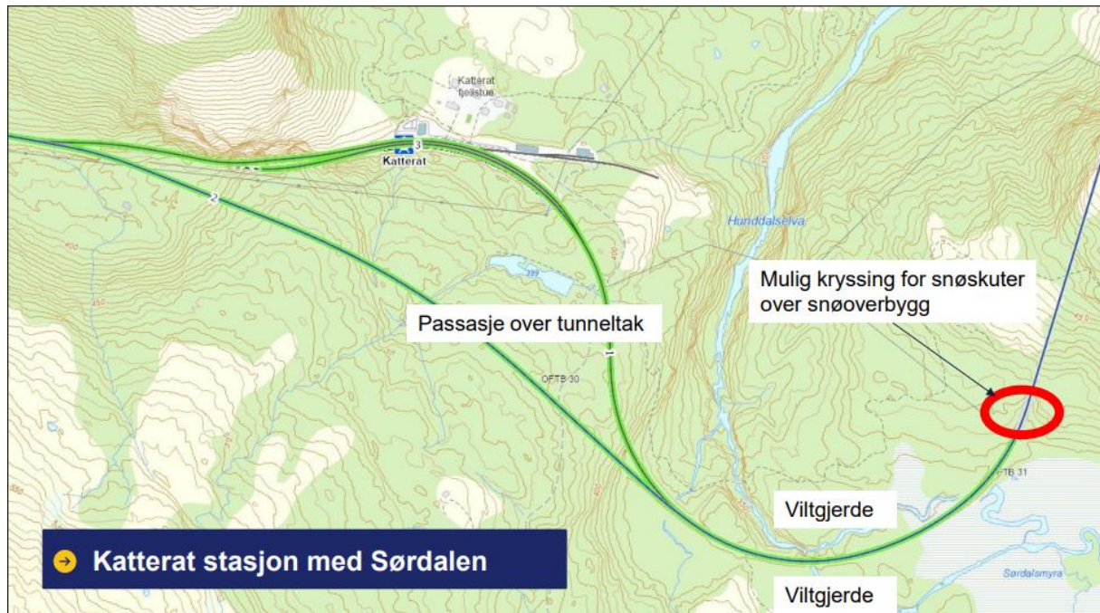
Figur 4.20. Reindriftstiltak på Katterat (Bane NOR 2025c).
