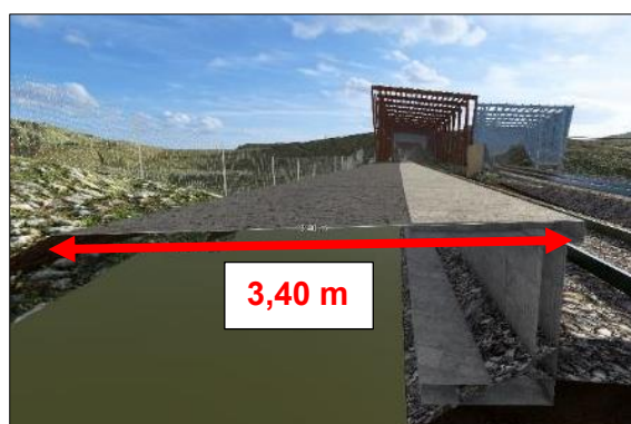
Figur 4-6: Utsnitt fra modell som viser snitt av plattform ved Haugfjell. Kilde: NIRAS
