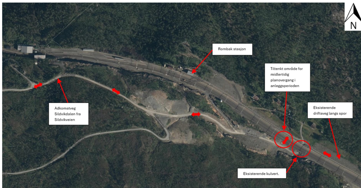
Figur 48 Oversiktsbilde over Rombak stasjon, som viser adkomstveg og omtrentlig plassering av midlertidig planovergang i anleggsfasen. Flyfoto: kommunekart.com
