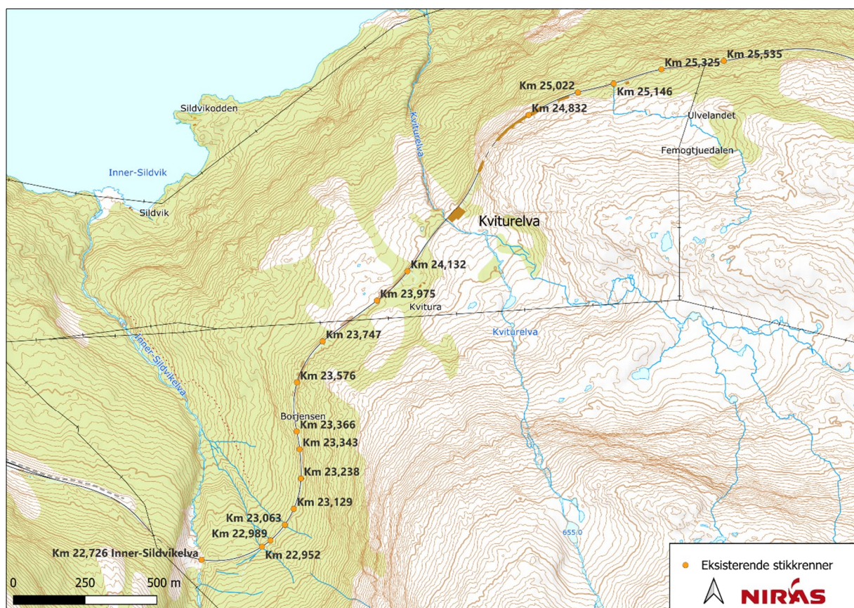
Figur 18: Viser oversikt over eksisterende stikkrenner innenfor planområdet.
