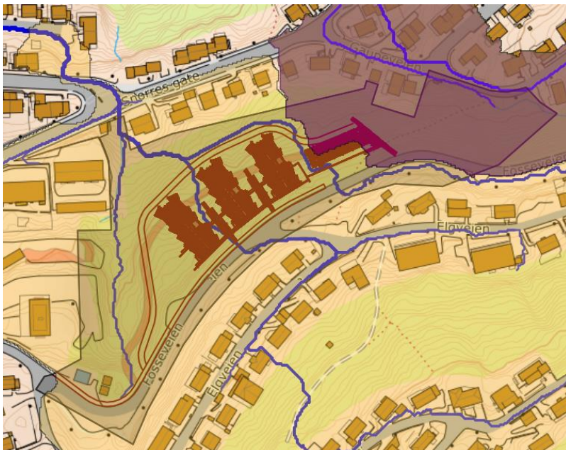
Figur 12: Fremtidig avrenningsmønster (inkl. feltinndelinger) ved etablering av ei overvannsgrøft nedstrøms gangstien / serviceveien. Overvannsgrøfta sørger for at nærmest alt overvann i/fra planområdet blir ledet til bekkeløpet vest for/i tiltaksområdet.
