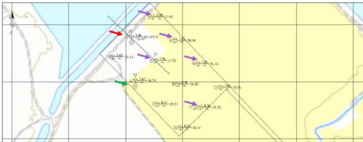
Figur 4-36: Grunnundersøkelser gjennomført av Sweco i 2021. Bekreftet sprøbruddsmateriale vist med rød pil, mistenkt sprøbruddsmateriale med lilla, prøve uten sprøbruddsegenskaper markert med grønt.
