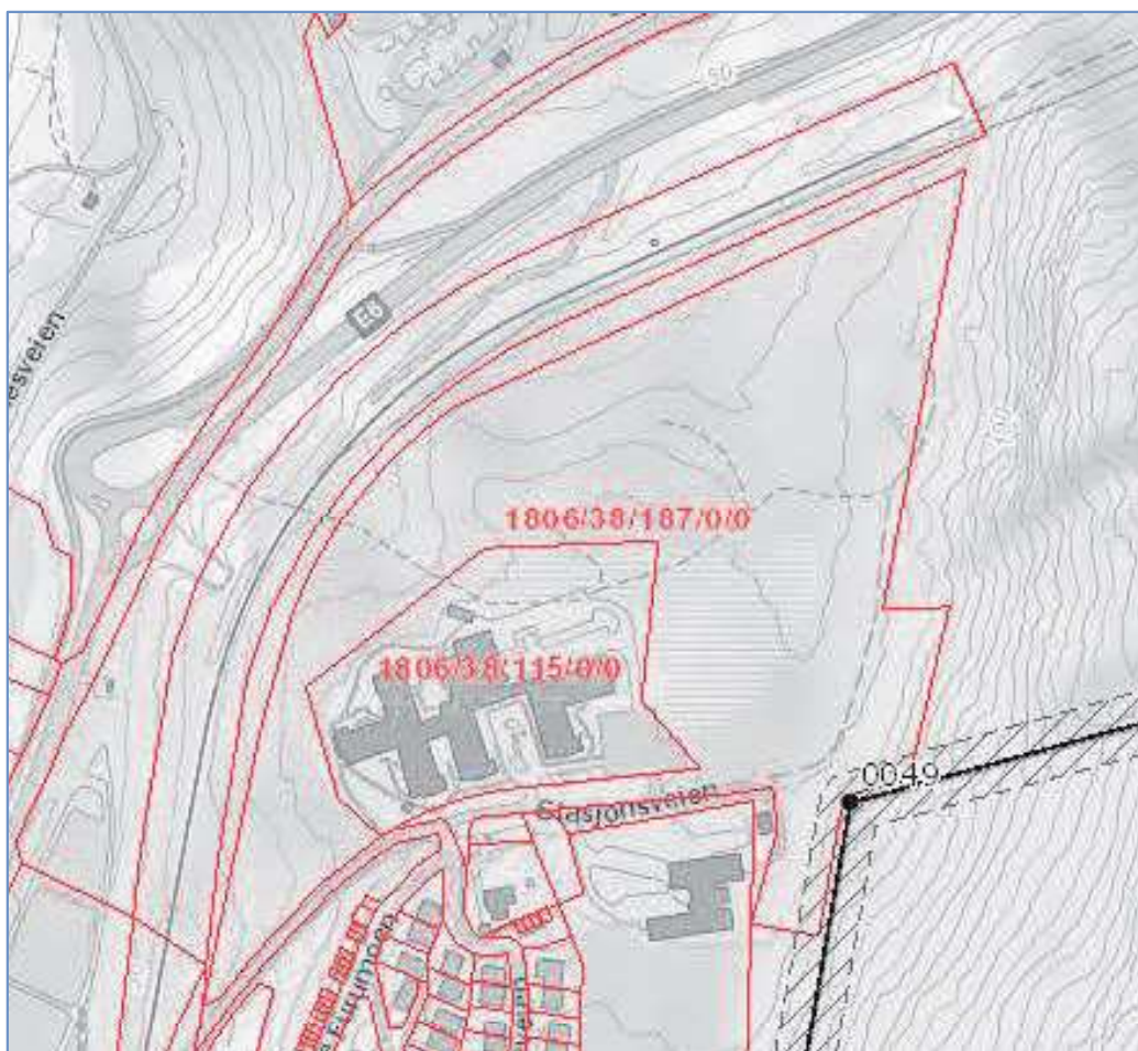
Situasjonskart: Statnetts 132 kV transmisjonsnettledning Kvandal-Narvik og tilhørende klausulert byggeforbudsbelte. Tunnel er planlagt rett under mast 49.
