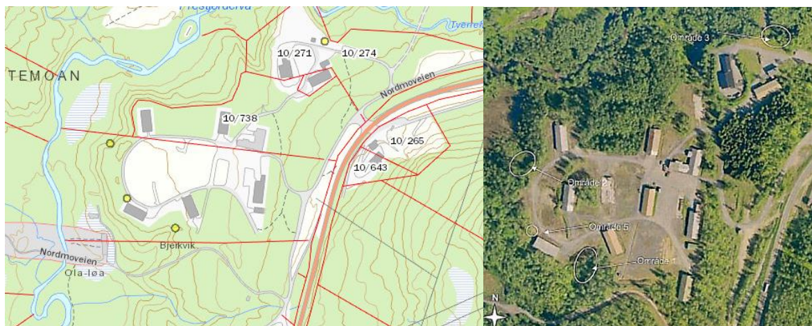
Figur 5-11: Kart til venstre: database grunnforurensning med markering av forurensset grunn (gule prikker). Høyre: De forurensede områdene hvor det er gjennomført tiltak (Forsvarsbygg/Norconsult 2011).
