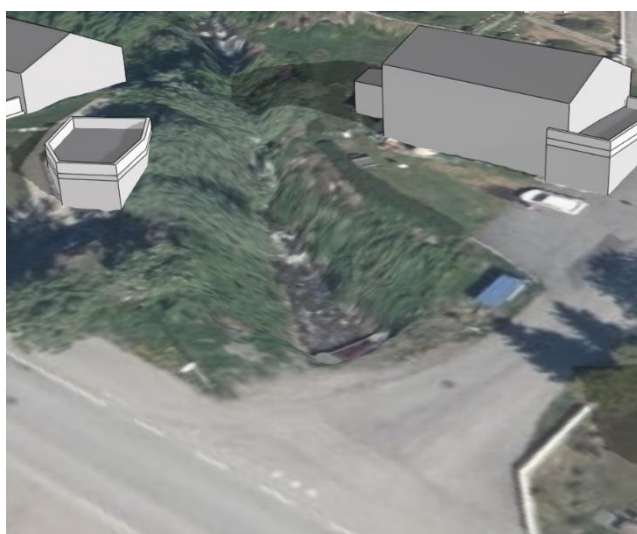
Figur 1: Utklipp fra Nordlandsatlas i 3D av området rundt inntak til overvannsrør viser at det er areal for oppstuving av vann ved flomsituasjoner.
