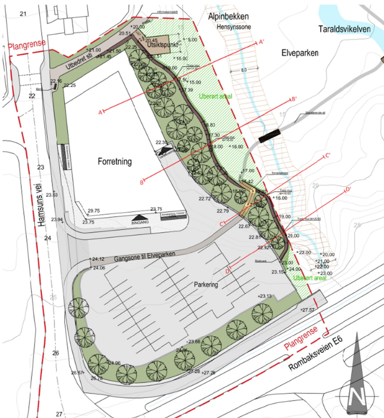
Figur 28 Illustrasjonen viser foreslått terrengbehandling og beplantning for det planlagte tiltaket. Kilde: Sweco Norge AS
