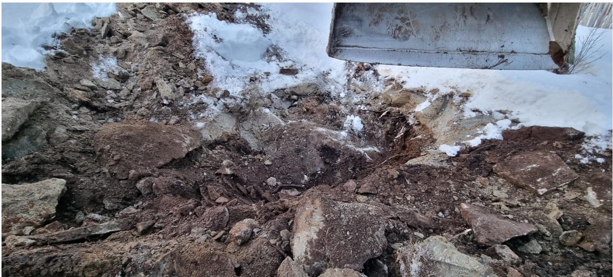
Bilde 1: Prøvegaving, berget er påvist på ca. 0,5 m dybden.
