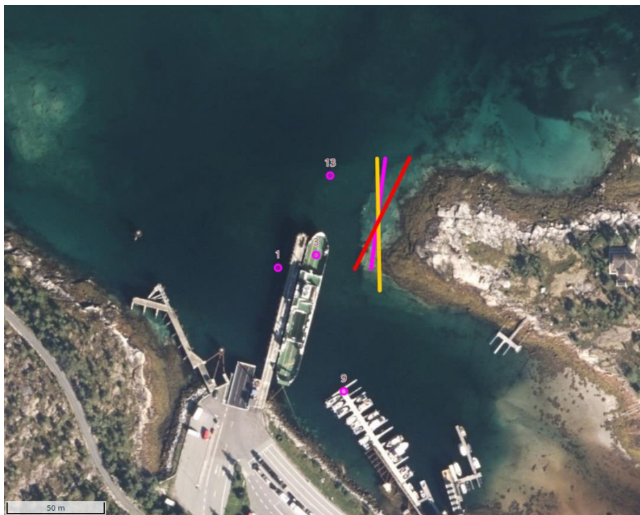
Figur 8 Oversiktskart over kaianlegg og bergnabb. Modell punkt er merket. De tre strekene representerer hvordan vinkelen til bergnabben er testet i bølgemodellen. Lilla: Rettet parallell med kaien, oransje: Rettet nord-sør, rød: rettet nordøst-sørvest. Kart: kystinfo.no
