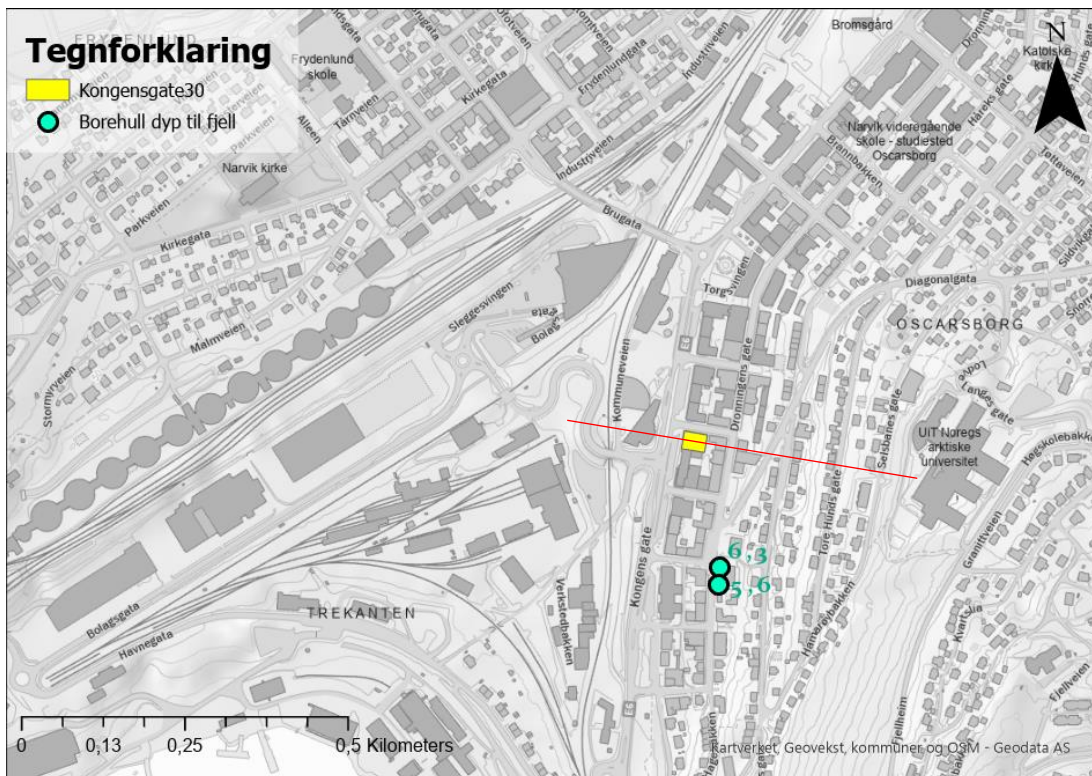
Figur 6 To stk. fjellbrønner som indikerer dybde til fjell. Rød strek viser lokalisering av høydeprofil i Figur 7.
