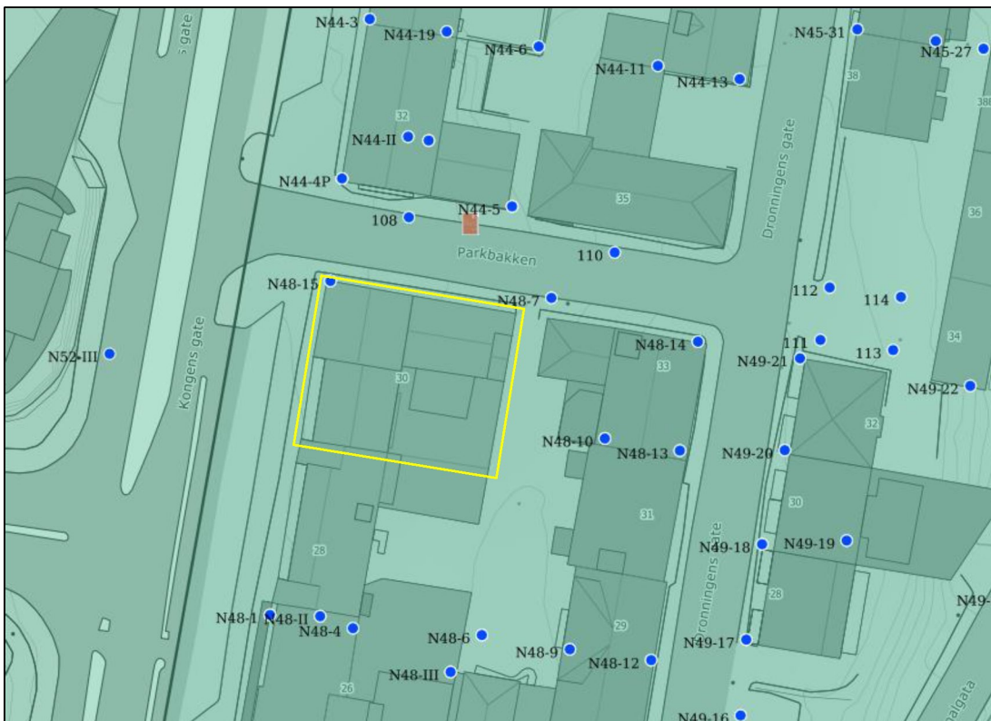
Figur 9 Blå punkter viser geotekniske borehull fra NADAG, gult rektangel indikerer eiendommen.
