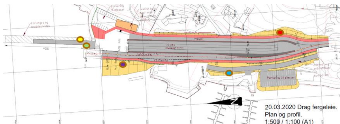
Figur 8: Skisse for anleggsarbeid på Drag. Plasseringen av støykildene i beregningene er markert med fargede sirkler (se fargekoding i Tabell 6).
