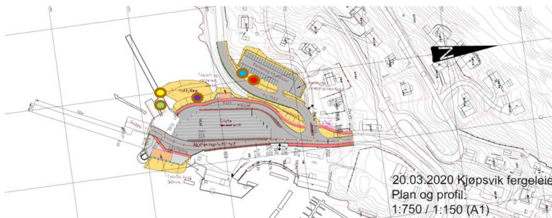
Figur 9: Skisse for anleggsarbeid i Kjøpsvik. Plasseringen av støykildene i beregningene er markert med fargede sirkler (se fargekoding i Tabell 6).
