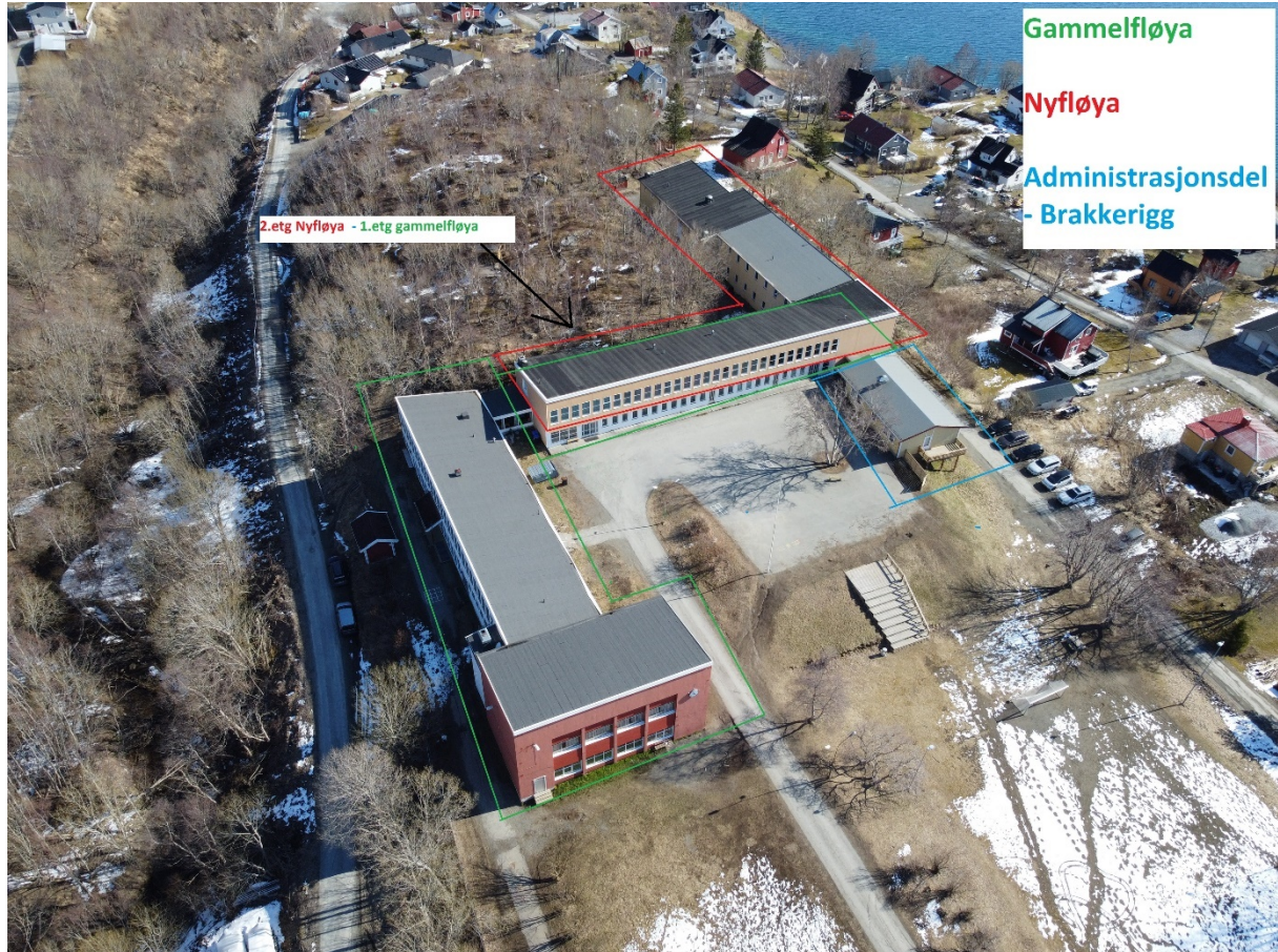
Figur 4: Kjøpsvik skole med avmerking av fløymerkinger. Gammelfløya er merket med grønt, nyfløya med rødt, og administrasjonsbygget med blått. Gammelfløya er igjen inndelt inn i spesialfløy (gymsal, svømmehall, skolekjøkken, naturfagsrom mm.) og klasseromsfløy (1. etasje markert med grønt). Rivesnittet vil gå i spesialfløya.
