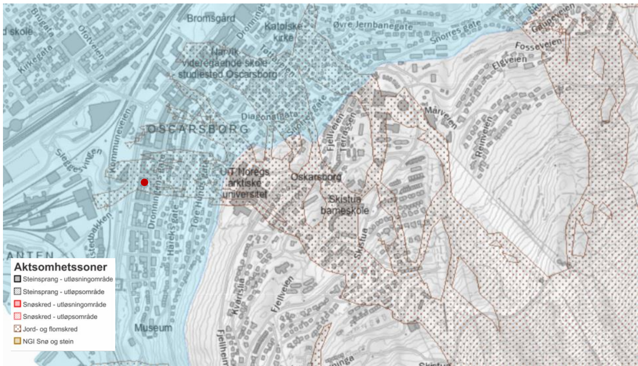
Figur 4: Aksomhetskart for jord- og flomskred. Marin grense vist med blå farge. Kongens gate 30 vist med rød farge. Kilde: NVE Atlas.
