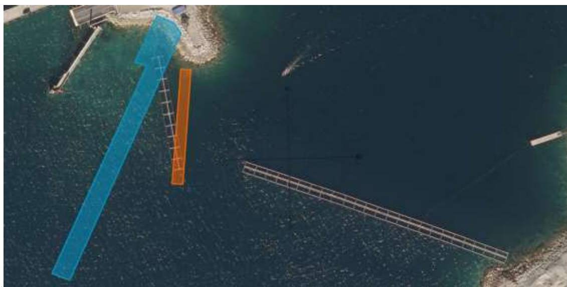
Figur 2 Foto over Kjøpsvik havn (kystinfo.no). Planlagt ny fergekai antydnet med blått omriss. Foreslått ny plassering av vestlige bølgedemper i oransje omriss. Dagens plassering av bølgedempere vises på fotoet.
