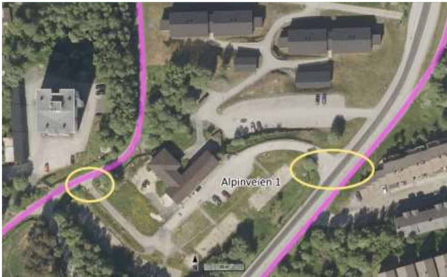
Figur 6-3: Gang- og sykkelveier på begge sider av planområdet, markert med rosa. Steder der planområdet vil få tilkobling til gang- og sykkelveinett er markert med gul sirkel. Kartgrunnlag hentet fra Norgeskart
