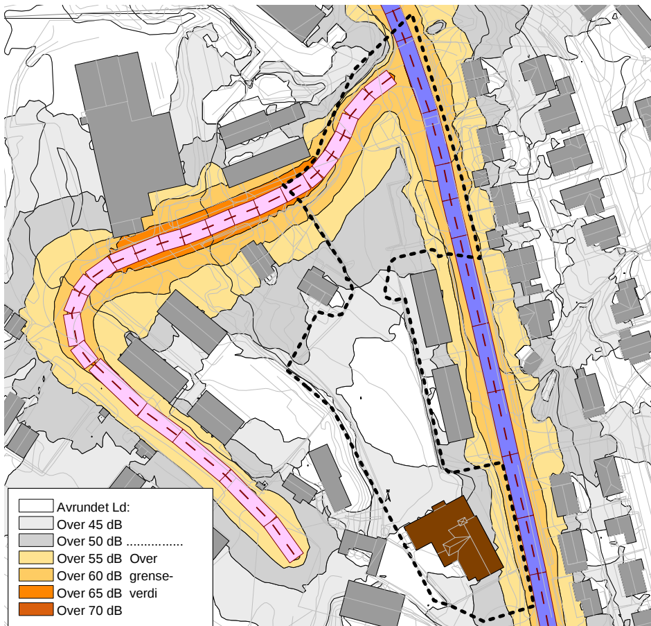
Figur 4 Støynivå, L_d , fra veg, beregnet 1,5 m over lokalt terreng.
