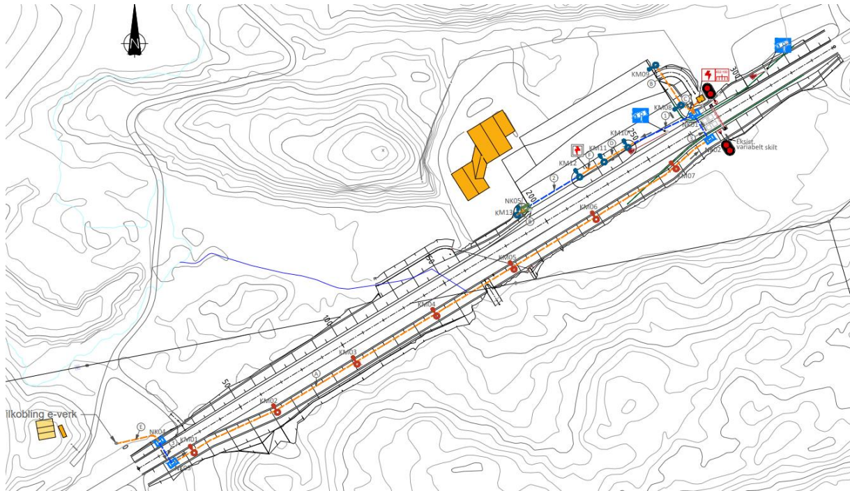
Figur 36. Prosjekterte tiltak for elektro
